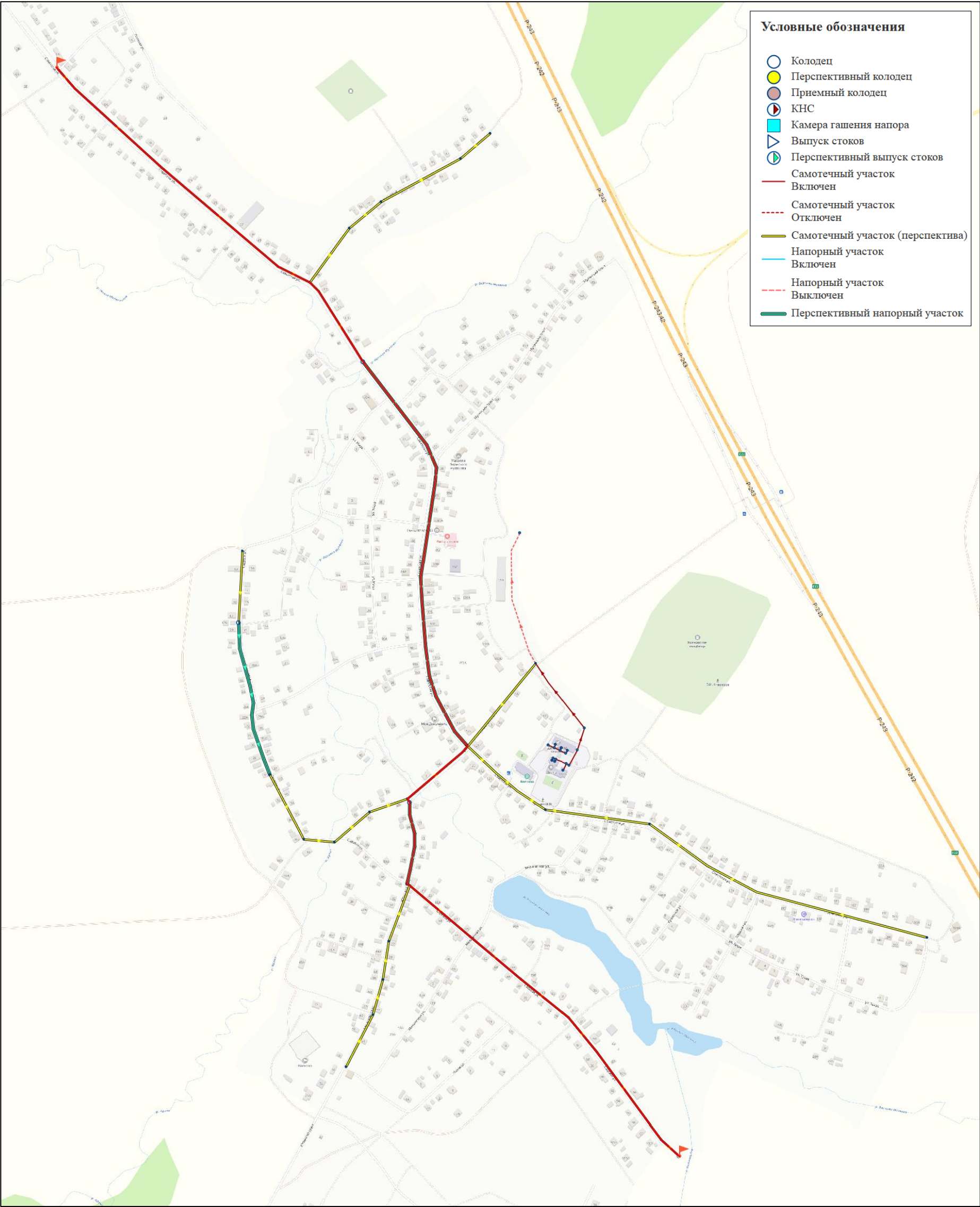
Рисунок 2.9 Путь построения продольного профиля от перспективного потребителя до КНС Кояново
