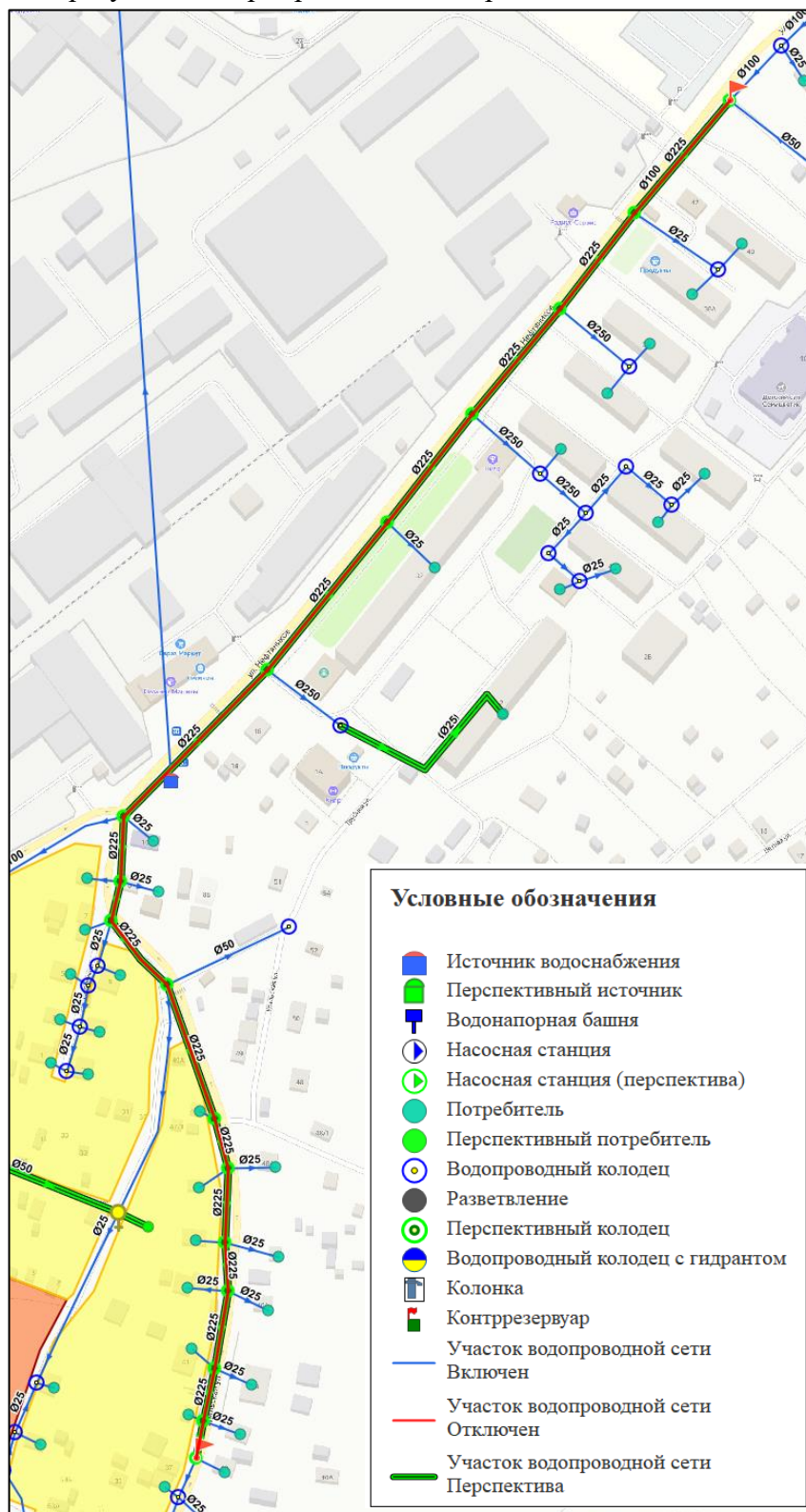
Рисунок 1.33 Планируемый к замене участок трубопровода в поселке Ферма.
