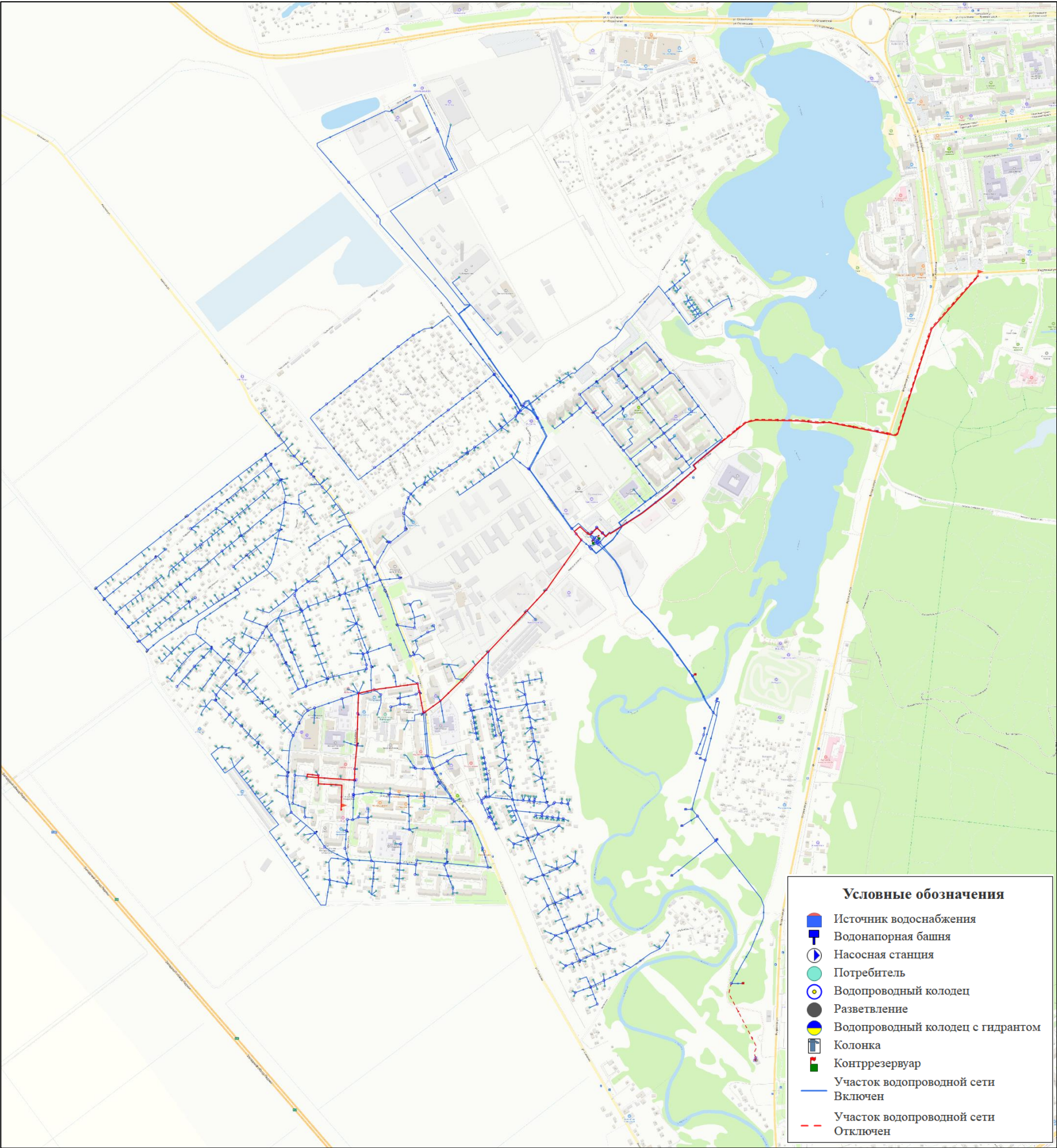
Рисунок 1.1 Путь построения пьезометрического графика от водозабора Кондратово Источник ВС ООО "Новогор-Прикамье" до Многоквартирного жилого дома ул. Культуры, д. 11
